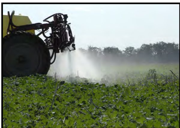
Zachowanie się cieczy roboczej przy użyciu rozpylaczy eżektorowych dwustrumieniowych bez środka antyznoszeniowego.
